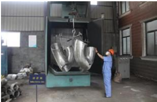
13 喷砂 / Sand Blasting
